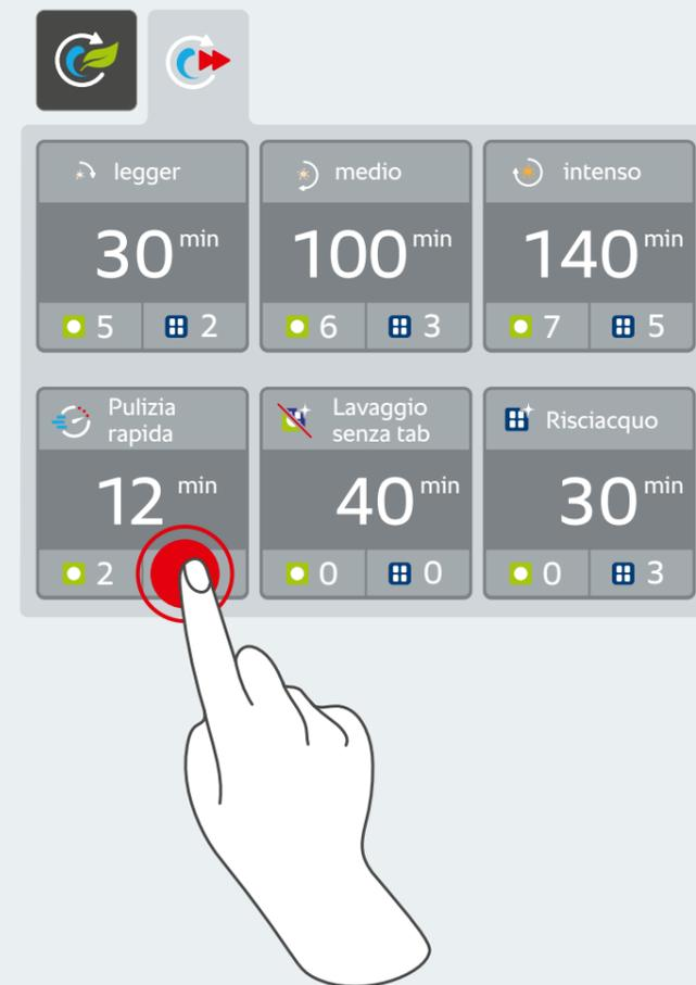
Pulizia rapida trovata e attivata in un lampo: basta posizionare le pastiglie detergenti nella canalina di scarico e avviare la pulizia. Già dopo 12 minuti la produzione può riprendere.
